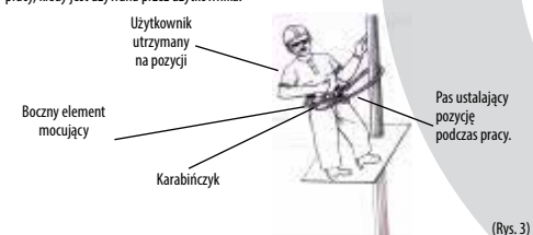
Należy upewnić się, że punkt kotwienia linki utrzymuje pozycję na poziomie talii użytkownika lub wyżej. Dwuokrotne zapętlenie linki jest zalecane, aby zapobiec zślizgnięciu się linki.
